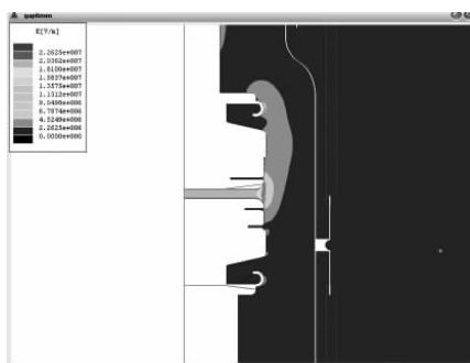
图3 触头开距 6 mm 时的电场强度分布
